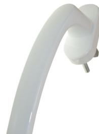
Fenstergriff Aluminium, runde Form, 45/90° Rasterung und 2 Schrauben vorgesteckt Dorn 37,40+45/7 mm abschließbar
