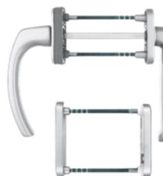
Fenstergriff Aluminium, runde Form innen und außen, 90° Rasterung mit passender PZ-Rosette für innen und außen, Dorn 7 x 120 mm und Schrauben M5 x 90 mm
